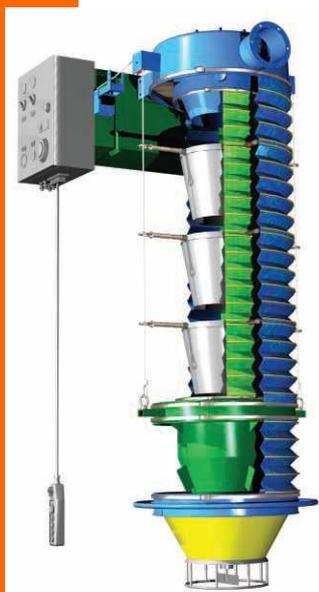
Los descargadores telescópicos ZG se utilizan para el llenado eficiente y controlado de camiones cisternas en materiales secos en polvo o granulares. Estos descargadores tienen conos internos para canalizar el flujo de material y de un doble fuelle exterior para la extracción de polvo. A la extremidad inferior el descargador tiene un cono de conexión con el camión revestido de polímero.
