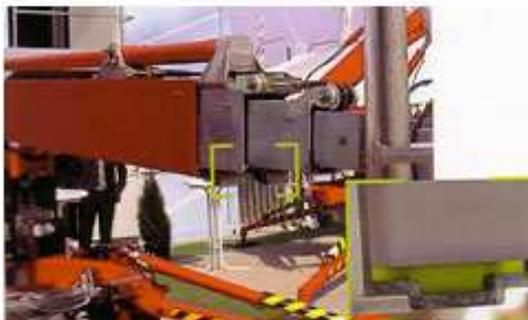
**El PE-1000 cerámico** alcanza en comparación con el estándar PE 1000 una vida útil mucho más larga, especialmente en su aplicación con altas velocidades en máquinas o cargas mecánicas. Ha demostrado su eficacia en numerosas aplicaciones por ej. como patín de guía para brazos telescópicos.
