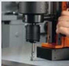
Roscado con acoplamiento de roscado
