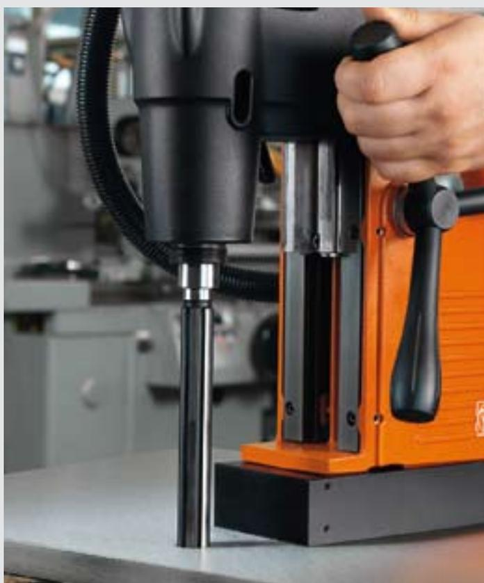
Para perforaciones exactas con la más alta precisión de acabado - escariado con unidades de perforación FEIN.
