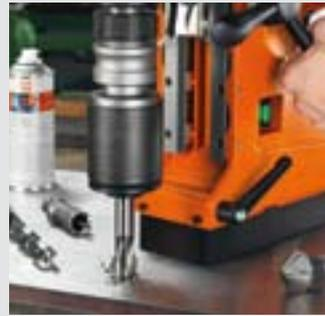
Las unidades de perforación con coronas FEIN tienen una gran versatilidad de aplicación. El portaherramientas de la máquina permite la utilización de las más diversas herramientas de trabajo para taladrar, roscar, escariar y avellanar.
