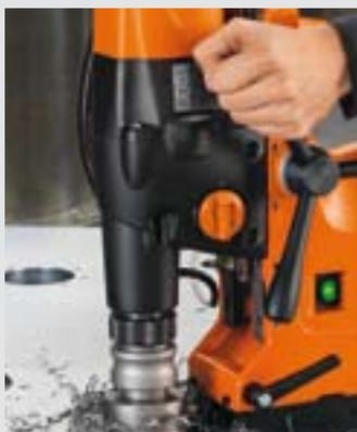
Las unidades de perforación con coronas FEIN están fabricadas para el uso en las más duras aplicaciones continuas a nivel industrial y profesional. Para estar a la altura de estas exigencias cuentan con algunas características constructivas especiales: Carcasa del motor de perforación de estructura tubular, caja de engranajes y bastidor de metal robusto – y no por último un motor de alta potencia diseñado para la más alta resistencia y potencia.
