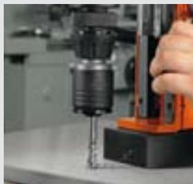
Roscado con portabrocas de cambio rápido para roscadoras
