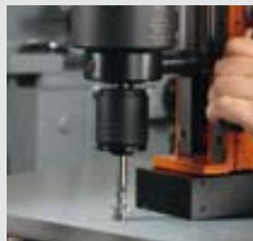
Roscado con acoplamiento de roscado
