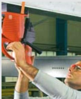
Las unidades de perforación con coronas FEIN son extremadamente ligeras y, por consiguiente, especialmente indicadas para trabajos de montaje in situ. Pero también como máquina de taller destaca por su óptima relación potencia/peso. La razón es su diseño compacto, componentes de aluminio en el bastidor, guía de cola de milano y caja de engranajes así como su compacto motor de alta potencia.
