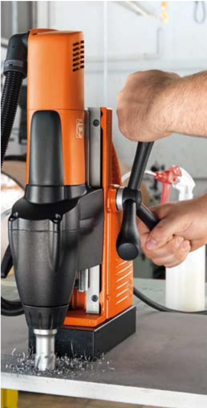
La lubricación refrigerante interior de las unidades de perforación con coronas FEIN permite trabajar de forma rápida y rentable, además de ofrecer una larga duración de la herramienta.
