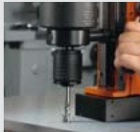
Roscado con acoplamiento de roscado
