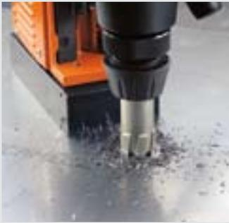
Con una velocidad de corte de hasta 45 m / min., las unidades de perforación con coronas\* FEIN consiguen de un rápido progreso de trabajo y una gran rentabilidad – en casi todos los materiales.
