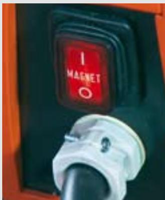
La máquina requiere un asiento seguro para poder convertir toda su fuerza en productividad. Con las unidades de perforación con coronas FEIN, al iniciar el taladrado aumenta de forma automática la ya de por sí elevada fuerza de sujeción magnética de los electroimanes. Incluso con altos pares de apriete en el eje del taladro, éste garantiza un asiento seguro del bastidor.
