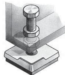
Para una óptima estabilidad de la máquina, es recomendable que la base ISOCOL sobresalga aprox. 10 mm de la base de la máquina. Se posicionarán los apoyos de manera que se repartan las cargas.
