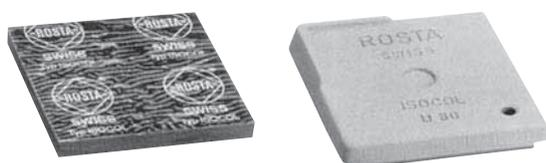
La base aislante ROSTA tipo ISOCOL es un eficaz sistema amortiguador. La base es autoadhesiva y resistente al aceite y a productos químicos. Tiene 3 capas y soporta temperaturas desde  $-40^{\circ}\text{C}$  hasta  $+80^{\circ}\text{C}$ . La base puede fijarse en el suelo ó en el bastidor de la máquina simplemente despegando el plástico protector de ambas caras. Puede aumentarse la adherencia humedeciéndolo con un nitro-disolvente.
